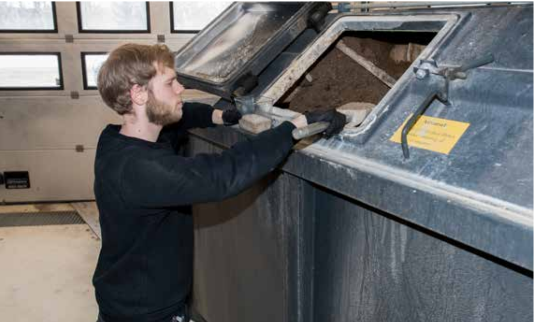
Sjekk av temperaturmålere for å dokumentere hygienisering.
